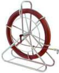
Ortungs-Röhrenschlange mit Glasfaserstab Ø 9 mm, Cu-Kern und PP Ummantelung komplett mit Anfangshülse M12 und Anfangsbirne mit Schäkel. Aufgespult auf verzinkter Stahlhaspel in stehender Ausführung mit Korbdurchmesser 630 mm.
