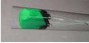
Fallschirm für den Einsatz in Rohr-ID Ø von 60 bis 100 mm. Sollte der Einsatz eines Shuttels nicht möglich sein kann die Zugschnur mit Hilfe des Fallschirms eingeblasen werden
