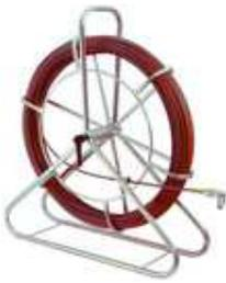
Ortungs-Röhrenschlange mit Glasfaserstab Ø 7,5 mm, Cu-Kern und PP Ummantelung komplett mit Anfangshülse M12 und Anfangsbirne mit Schäkel. Aufgespult auf verzinkter Stahlhaspel in stehender Ausführung mit Korbdurchmesser 630 mm.
