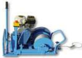
Trommelwinde mit mechanischem Antrieb und geringen Abmessungen von Gesamt LxBxH = 950x450x720 mm. Optionen siehe PDF-Details.
