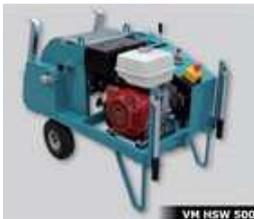
Hydraulische Trommelwinde, geeignet für die unterirdische Kabelverlegung. Antrieb hydraulisch durch einen Benzin- oder Elektromotor. Die maximale Zugkraft wirkt direkt auf der Seilspeichertrommel. Montiert auf einem robusten Grundrahmengestell mit Fahrachse und ausgestattet mit einer hydraulisch wirkenden Messuhr mit Abschaltautomatik.
