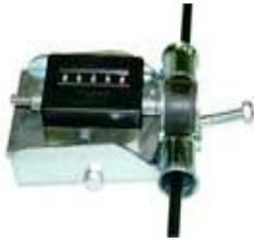
Mechanischer Zähler zur Messung der auf- bzw. abgespulten Länge, montierbar auf Haspel.
