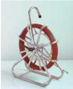
Ortungs-Röhrenschlange mit Glasfaserstab Ø 4,5 mm, Cu-Kern und PP Ummantelung komplett mit Anfangshülse M5 und Zugkopf M5 mit Öse. Aufgespult auf verzinkter Stahlhaspel in stehender Ausführung mit Korbdurchmesser 330 mm.
