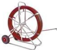
Ortungs-Röhrenschlange mit Glasfaserstab Ø 9 mm, Cu-Kern und PP Ummantelung komplett mit Anfangshülse M12 und Anfangsbirne mit Schäkel. Aufgespult auf verzinkter Stahlhaspel in fahrbarer Ausführung mit Korbdurchmesser 790 mm (bis 80 m) bzw 1000 mm (über 80 m).
