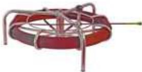
Ortungs-Röhrenschlange mit Glasfaserstab Ø 6 mm, Cu-Kern und PP Ummantelung komplett mit Anfangshülse M6 und Zugkopf M6 mit Öse. Aufgespult auf verzinkter Stahlhaspel in fahrbarer Ausführung mit Korbdurchmesser 550 mm.
