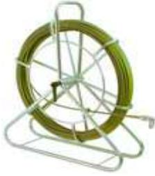
Röhrenschlange mit Glasfaserstab Ø 7,5 mm und PP Ummantelung komplett mit Anfangshülse M12 und Anfangsbirne mit Schäkel. Aufgespult auf verzinkter Stahlhaspel in stehender Ausführung mit Korbdurchmesser 630 mm.
