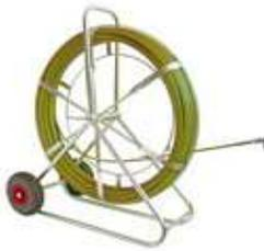
Röhrenschlange mit Glasfaserstab Ø 11 mm und PP Ummantelung komplett mit Anfangshülse M12 und Anfangsbirne mit Schäkel. Aufgespult auf verzinkter Stahlhaspel in fahrbarer Ausführung mit Korbdurchmesser 1000 mm und Korbbreite 150 mm (bis 200 m) bzw. 230 mm (über 200 m).
