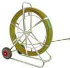
Röhrenschlange mit Glasfaserstab Ø 9 mm und PP Ummantelung komplett mit Anfangshülse M12 und Anfangsbirne mit Schäkel. Aufgespult auf verzinkter Stahlhaspel in fahrbarer Ausführung mit Korbdurchmesser 790 mm (bis 80 m) bzw 1000 mm (über 80 m).
