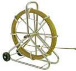
Röhrenschlange mit Glasfaserstab Ø 6 mm und PP Ummantelung komplett mit Anfangshülse M6 und Zugkopf M6 mit Öse. Aufgespult auf verzinkter Stahlhaspel in horizontaler Ausführung mit Korbdurchmesser 550 mm.
