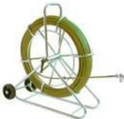
Röhrenschlange mit Glasfaserstab Ø 7,5 mm und PP Ummantelung komplett mit Anfangshülse M12 und Anfangsbirne mit Schäkel. Aufgespult auf verzinkter Stahlhaspel in fahrbarer Ausführung mit Korbdurchmesser 630 mm.
