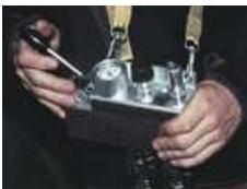
Hydraulische Fernbedienung mit Geschwindigkeits- und Zug-/Druckkraftregelung in beide Richtungen.
