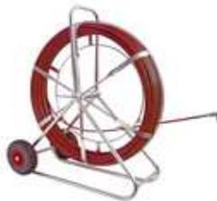
Ortungs-Röhrenschlange mit Glasfaserstab Ø 7,5 mm, Cu-Kern und PP Ummantelung komplett mit Anfangshülse M12 und Anfangsbirne mit Schäkel. Aufgespult auf verzinkter Stahlhaspel in fahrbarer Ausführung mit Korbdurchmesser 630 mm.
