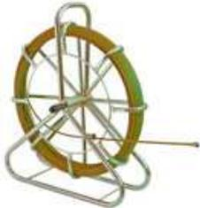
Röhrenschlange mit Glasfaserstab Ø 6 mm und PP Ummantelung komplett mit Anfangshülse M6 und Zugkopf M6 mit Öse. Aufgespult auf verzinkter Stahlhaspel in stehender Ausführung mit Korbdurchmesser 550 mm.
