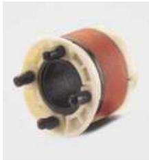
Rohr- und Kabel-Dichtstopfen für 1 Elektrokabel. Geteilte Ausführung, zerlegbar. Auch zum späteren Abdichten geeignet. Kunststoffausführung mit Edelstahlschrauben, korrosionsfest.
