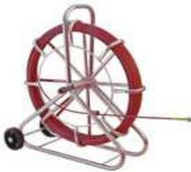
Ortungs-Röhrenschlange mit Glasfaserstab Ø 6 mm, Cu-Kern und PP Ummantelung komplett mit Anfangshülse M6 und Zugkopf M6 mit Öse. Aufgespult auf verzinkter Stahlhaspel in fahrbarer Ausführung mit Korbdurchmesser 550 mm.
