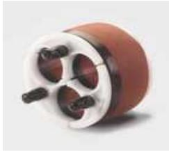
Rohr- und Kabel-Dichtstopfen für 3 Elektrokabel. Geteilte Ausführung, zerlegbar. Auch zum späteren Abdichten geeignet. Kunststoffausführung mit Edelstahlschrauben, korrosionsfest.
