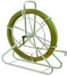
Röhrenschlange mit Glasfaserstab Ø 9 mm und PP Ummantelung komplett mit Anfangshülse M12 und Anfangsbirne mit Schäkel. Aufgespult auf verzinkter Stahlhaspel in stehender Ausführung mit Korbdurchmesser 630 mm.
