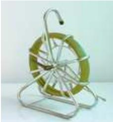
Röhrenschlange mit Glasfaserstab Ø 4,5 mm und PP Ummantelung komplett mit Anfangshülse M5 und Zugkopf M5 mit Öse. Aufgespult auf verzinkter Stahlhaspel in stehender Ausführung mit Korbdurchmesser 330 mm.
