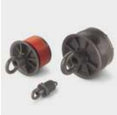
Rohr-Dichtstopfen mit Ösenschraube zum Abdichten von leeren Rohren gegen Eindringen von Wasser und Schlamm vor der Kabelverlegung. Ganz Kunststoffausführung, korrosionsfest. Wasser- und luftdicht bis 0,5 bar
